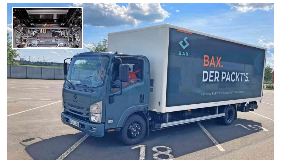
Alles in einer: Der Bax hat zwei Motoren in der Hinterachse. Fotos Boris Schmidt
